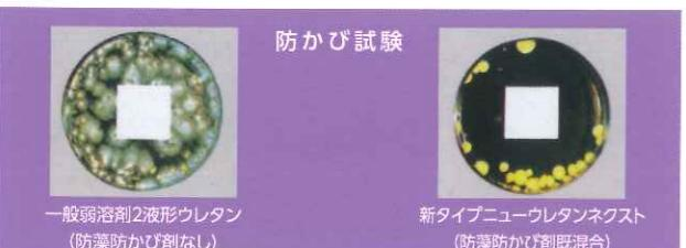
塗料を塗布した試験片(3×3cm)を寒天培地上にはり付けしたのち、混合かび胞子懸濁液を噴霧。かびの発生度合を比較する。
