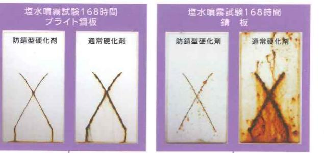
それぞれの試験板に塗装後(乾燥膜厚60μm)、素地に到達するクロスカットをいれ、塩水を168時間連續噴霧。クロスカット部の発さび程度、発さびの幅を比較する。
